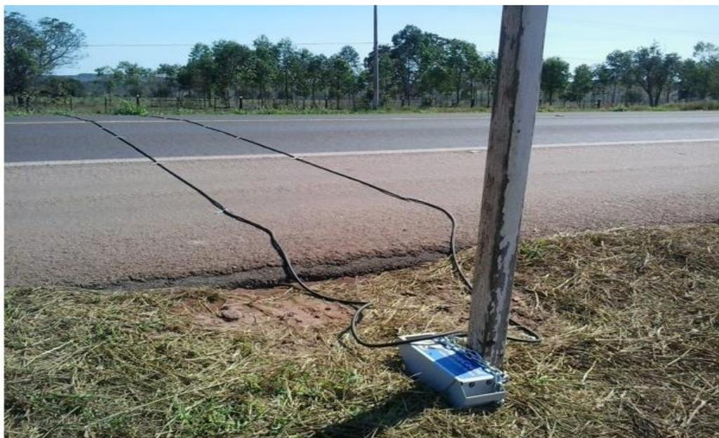
Figura 12 - Equipamento utilizado na contagem automática de tráfego
